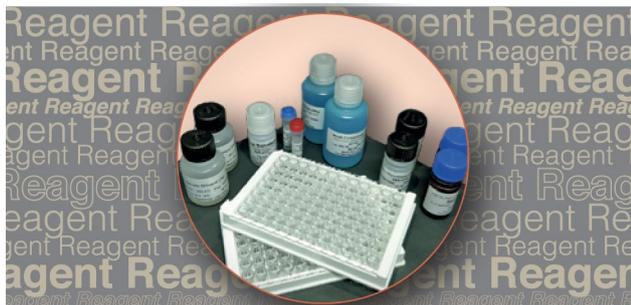
Ingrédients chimiques qui sont ajoutés pour tester l'échantillon d'un patient afin de voir si une réaction se produit. Un changement de couleur, d'intensité lumineuse ou toute autre différence peut survenir. Le changement est mesuré par rapport à un changement connu ou à un contrôle, puis calculé pour le résultat du test.
